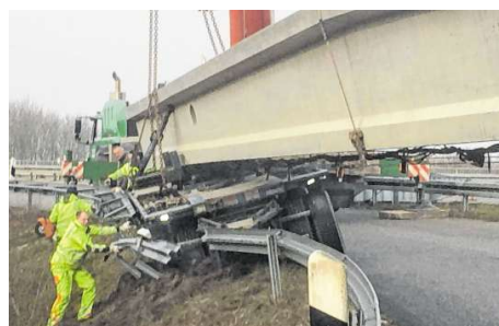
Mit einem Brückenteil blieb dieser Schwerlasttransporter an der Leitplanke der Autobahnabfahrt Schwetzingen hängen und blockierte stundenlang den Verkehr. Die Arbeiter mussten mit Schweißgeräten die Leitplanke kappen und aufpassen, nicht selbst unter die unter Druck stehenden Metallteile zu geraten.
